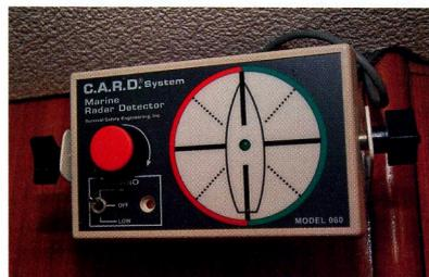
船内に設置されたレーダーディテクター。レーダーの電波を受信することで、その相手船の方位を示すという航海機器である
