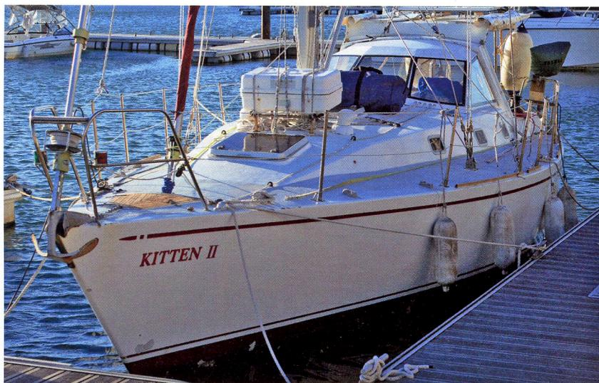
〈キトンII〉はウッドコアFRP製の自作艇。全長12m、全幅3.9m、吃水1.5m、排水量7.6トン。設計はヴァンデスユタット(オランダ)によるもので、カッターリグ仕様。乾舷が低いのも特徴だ
