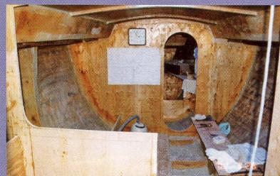
⑥ 作業中の船内の様子。正面は、メインサロンとフォックスルの間のバルクヘッドで、米松を使っている
